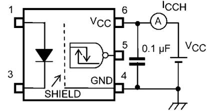
**Fig. 12.1.4 I<sub>CCH</sub> Test Circuit**
