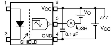
**Fig. 12.1.6 I<sub>OSH</sub> Test Circuit**
