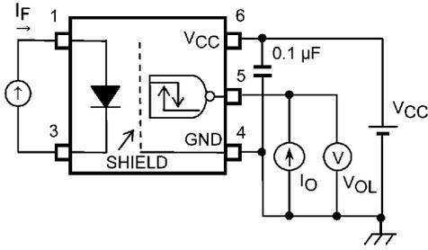
**Fig. 12.1.1 V<sub>OL</sub> Test Circuit**
