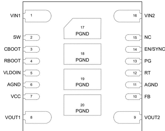
图 6-1. 20-Pin QFN RDL Package (Top View)
