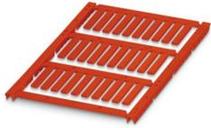
导线标记， 标签纸， 红色， 未标记， 适用的打印机： TOPMARK NEO， TOPMARK LASER， BLUEMARK ID COLOR， BLUEMARK ID， BLUEMARK CLED， THERMOMARK PRIME， THERMOMARK CARD 2.0， THERMOMARK CARD， 安装方式: 插入， 电缆直径范围: 1.5 ... 35 mm， 标识区域大小: 23 x 4 mm， 标签数: 30
