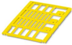
导线标记, 标签纸, 黄色, 未标记, 适用的打印机: BLUEMARK ID COLOR, BLUEMARK ID, BLUEMARK CLED, PLOTMARK, CMS-P1-PLOTTER, 安装方式: 插入, 电缆直径范围: 1.5 ... 35 mm, 标识区域大小: 23 x 4 mm, 标签数: 24
