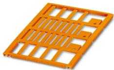
导线标记, 标签纸, 橙色, 未标记, 适用的打印机: BLUEMARK ID COLOR, BLUEMARK ID, BLUEMARK CLED, PLOTMARK, CMS-P1-PLOTTER, 安装方式: 插入, 电缆直径范围: 1.5 ... 35 mm, 标识区域大小: 23 x 4 mm, 标签数: 24
