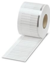
电缆标识，盘卷，白色，未标记，适用的打印机：THERMOMARK E.300 (D)/600 (D)，THERMOMARK ROLL 2.0，THERMOMARK ROLL，THERMOMARK ROLL X1，THERMOMARK ROLLMASTER 300/600，THERMOMARK X1.2，安装方式：插入，电缆直径范围：1.5 ... 35 mm，标识区域大小：23 x 4 mm，标签数：3000
