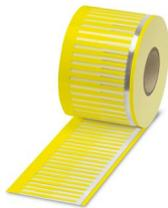
电缆标识，盘卷，黄色，未标记，适用的打印机：THERMOMARK E.300 (D)/600 (D)，THERMOMARK ROLL 2.0，THERMOMARK ROLL，THERMOMARK ROLL X1，THERMOMARK ROLLMASTER 300/600，THERMOMARK X1.2，安装方式：插入，电缆直径范围：1.5 ... 35 mm，标识区域大小：23 x 4 mm，标签数：3000
