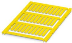
导线标记， 标签纸， 黄色， 未标记， 适用的打印机： TOPMARK NEO， TOPMARK LASER， BLUEMARK ID COLOR， BLUEMARK ID， BLUEMARK CLED， THERMOMARK PRIME， THERMOMARK CARD 2.0， THERMOMARK CARD， 安装方式: 插入， 电缆直径范围: 1.5 ... 35 mm， 标识区域大小: 23 x 4 mm， 标签数: 30
