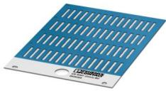
电缆标识，卡，蓝色，未标记，适用的打印机：BLUEMARK ID COLOR，BLUEMARK ID，THERMOMARK PRIME，THERMOMARK CARD 2.0，THERMOMARK CARD，安装方式：滑插式，电缆直径范围：1.5 ... 35 mm，标识区域大小：23 x 4 mm，标签数：56
