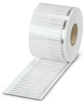
电缆标识，盘卷，白色，未标记，适用的打印机：THERMOMARK E.300 (D)/600 (D)，THERMOMARK ROLL 2.0，THERMOMARK ROLL，THERMOMARK ROLL X1，THERMOMARK ROLLMASTER 300/600，THERMOMARK X1.2，安装方式：插入，电缆直径范围：0.6 ... 50 mm，标识区域大小：15 x 4 mm，标签数：3000
