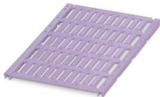
导线标记，标签纸，紫色，未标记，适用的打印机：TOPMARK NEO，TOPMARK LASER，BLUEMARK ID COLOR，BLUEMARK ID，BLUEMARK CLED，THERMOMARK PRIME，THERMOMARK CARD 2.0，THERMOMARK CARD，安装方式：插入，电缆直径范围：0.6 ... 50 mm，标识区域大小：15 x 4 mm，标签数：50
