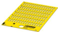
电缆标识，卡，黄色，未标记，适用的打印机：BLUEMARK ID COLOR，BLUEMARK ID，THERMOMARK PRIME，THERMOMARK CARD 2.0，THERMOMARK CARD，安装方式：滑插式，电缆直径范围：0.6 ... 50 mm，标识区域大小：15 x 4 mm，标签数：84
