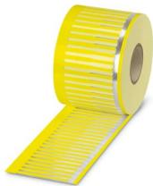
电缆标识，盘卷，黄色，未标记，适用的打印机：THERMOMARK E.300 (D)/600 (D)，THERMOMARK ROLL 2.0，THERMOMARK ROLL，THERMOMARK ROLL X1，THERMOMARK ROLLMASTER 300/600，THERMOMARK X1.2，安装方式：插入，电缆直径范围：0.6 ... 50 mm，标识区域大小：15 x 4 mm，标签数：3000
