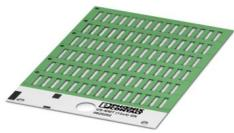
电缆标识，卡，绿色，未标记，适用的打印机：BLUEMARK ID COLOR，BLUEMARK ID，THERMOMARK PRIME，THERMOMARK CARD 2.0，THERMOMARK CARD，安装方式：滑插式，电缆直径范围：0.6 ... 50 mm，标识区域大小：15 x 4 mm，标签数：84
