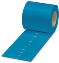
插芯标签，盘卷，蓝色，未标记，适用的打印机：THERMOMARK E.300 (D)/600 (D)，THERMOMARK ROLL 2.0，THERMOMARK ROLL，THERMOMARK ROLL X1，THERMOMARK ROLLMASTER 300/600，THERMOMARK X1.2，安装方式：插入，电缆直径范围：0.6 ... 50 mm，标识区域大小：15 x 4 mm，标签数：7500
