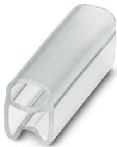
导线标记条支架，透明，未标记，安装方式: 滑插式，电缆直径范围: 1.5 ... 2.5 mm，标识区域大小: 15 x 4 mm
