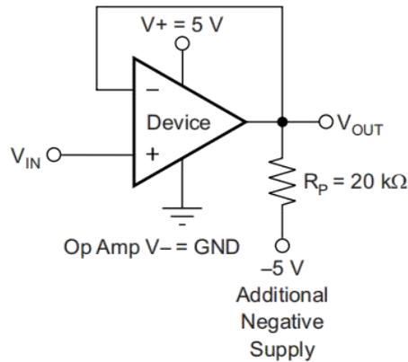
Figure 19. V<sub>OUT</sub> 接地范围
