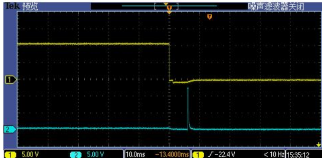
图 3 GM8023 继电器关断波形
