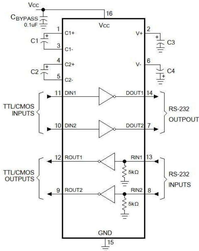
引脚连接到 RS232 连接器端口或者 RS232 总线上。为了能正常工作，请参照表 3 选择合适的电容。
