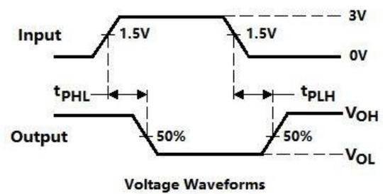
图3: 驱动器波形时序图
