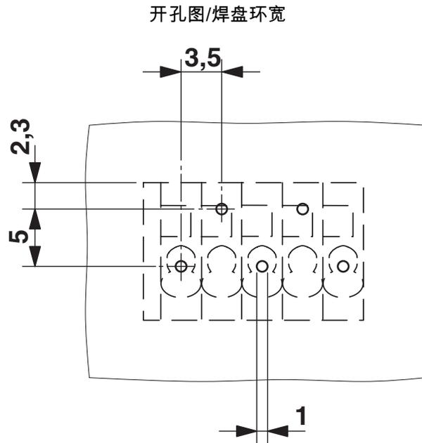
图为5位连接器的钻孔图——Z型排列的焊针位于连接器右侧。可根据需要提供其它类型的焊针。
