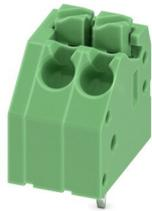
固定式连接器，额定电流: 8 A，额定电压(III/2): 400 V，额定横截面: 1.5 mm<sup>2</sup>，电位数: 2，行数: 1，每行位数: 2，产品系列: PTSA 1,5，针距: 3.5 mm，接线方式: 直插式弹簧连接，安装: 波峰焊，导线/PCB连接方向: 45°，颜色: 绿色，针脚排列: Z型针脚M，焊针[P]: 3.5 mm，每个电势的焊针数量: 1，包装类型: 纸箱包装。焊针错位，双排
