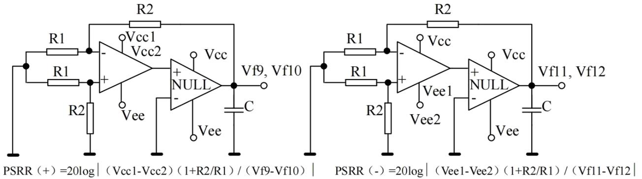
电源纹波抑制比 PSRR 测试图
