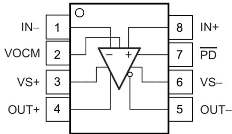
图 6-1. DGK Package 8-Pin VSSOP Top View
