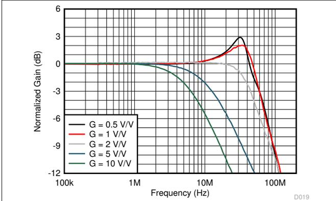
V<sub>O</sub> = 200 mV<sub>PP</sub>, see 图 8-1 and 表 10-1 for resistor values
