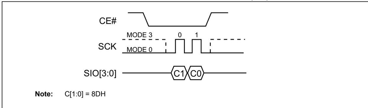
**FIGURE 5-41: LOCK-DOWN BLOCK PROTECTION REGISTER (SPI)**
