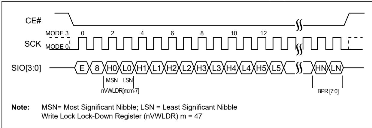
**FIGURE 5-43: WRITE LOCK LOCK-DOWN REGISTER SEQUENCE (SPI)**
