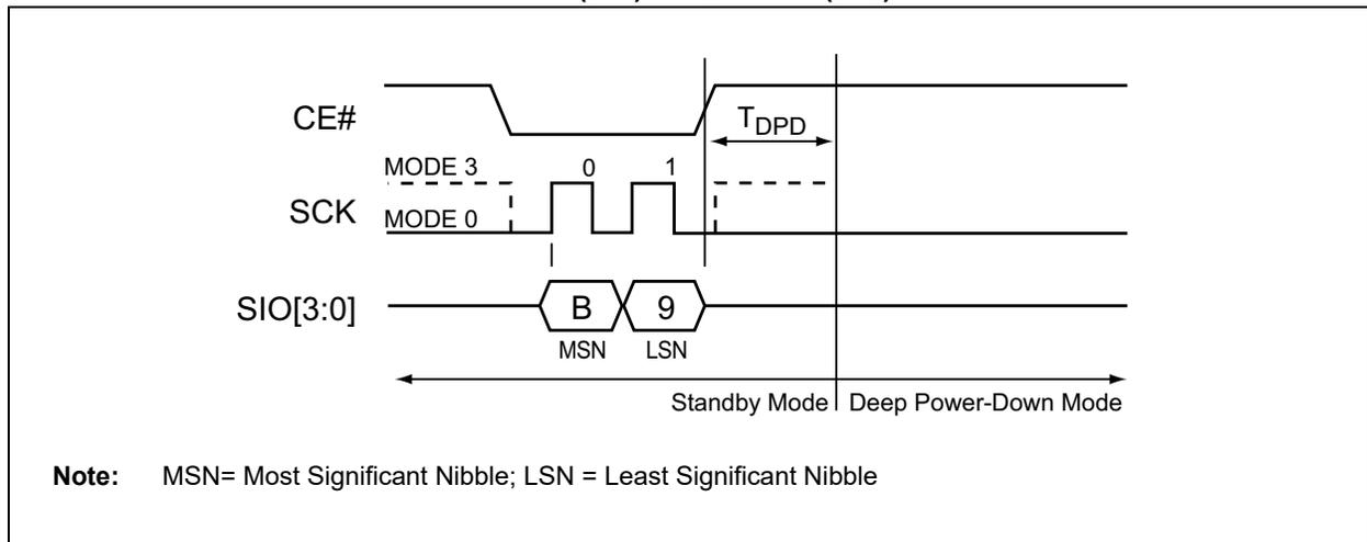
FIGURE 5-47: DEEP POWER-DOWN (DPD) SEQUENCE (SPI)
