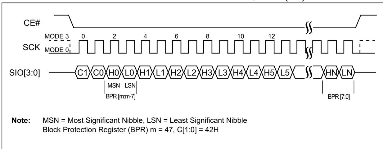
**FIGURE 5-39: WRITE BLOCK PROTECTION REGISTER SEQUENCE (SPI)**
