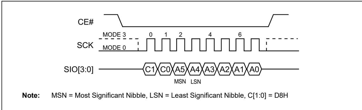
FIGURE 5-22: BLOCK ERASE SEQUENCE (SPI)
