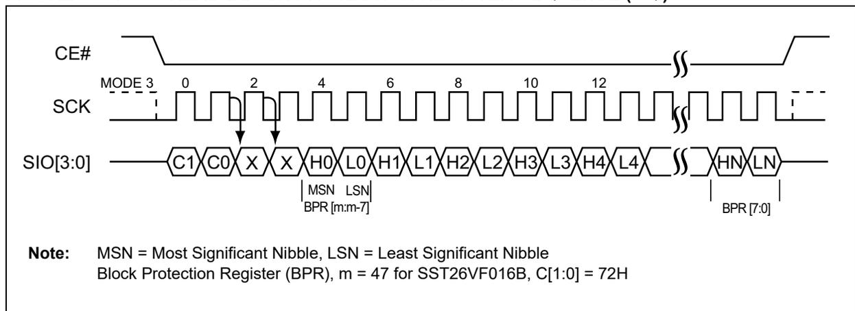
FIGURE 5-37: READ BLOCK PROTECTION REGISTER SEQUENCE (SPI)
