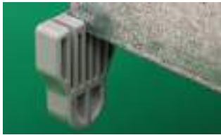
提供的标准挂钩和底角安装无需工具，因此底板可在控制箱内以7种不同深度安装，并且可在 3 个位置调节。
