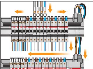
通过供电套件和并联的电缆供电。
