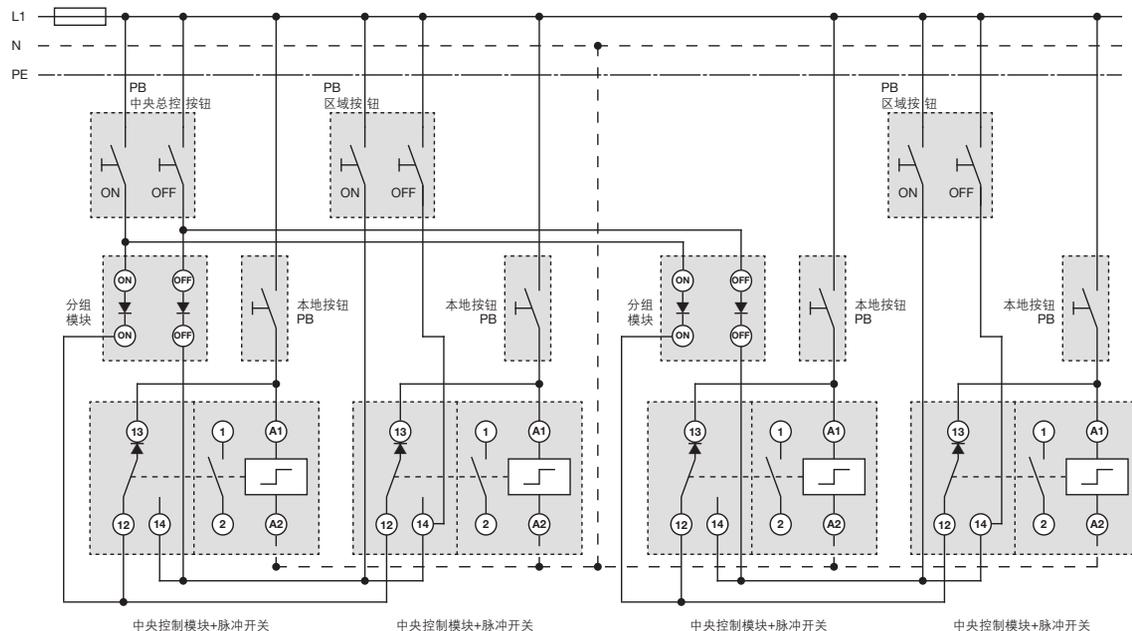
E290 与 E293/X和E295-GM分组模块配合进行中央开关控制的应用示例：控制方案中集成了分组模块，以控制不同区域的照明组合。本地按钮可以单独控制各个脉冲开关。集成分组模块后，则可以将负载分成两组。按下“区域控制”按钮后，可以独立开关各组负载。“中央控制总”按钮则可以一次将所有E290脉冲开关切换到目标位置（ON/OFF）。
