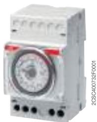
根据预定程序控制回路的开关和闭合，产品分为每日定时和每周定时两种类型，均配有 16A 触点。它们可在预定程序内设置，或通过永久 ON 功能设置 (ON-OFF 仅适用于 AT3)。带 R 型产品内置电池，可在长时间断电 (最高达 200h) 时保持设置的时间。该电池可通过电网电压充电。并适用于商场照明系统、公共建筑、学校、采暖和灌溉系统等应用场合。
