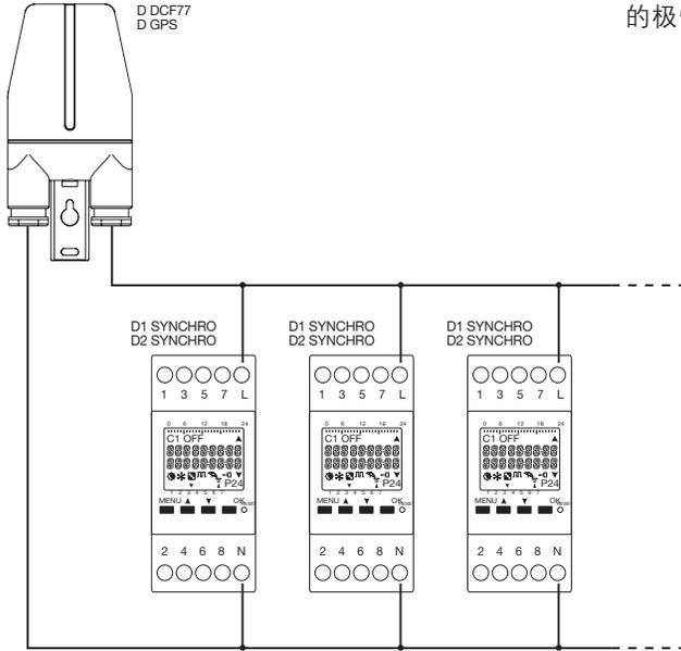
D DCF77 或 D GPS 天线最多可控制 10 个仪器。第一个仪器的极性可忽略，但其它仪器的极性必须与第一个的一致。
