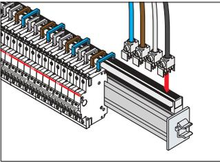
母排采用 100A 供电套件供电（不带电缆）。端子接线能力 35mm<sup>2</sup>。
