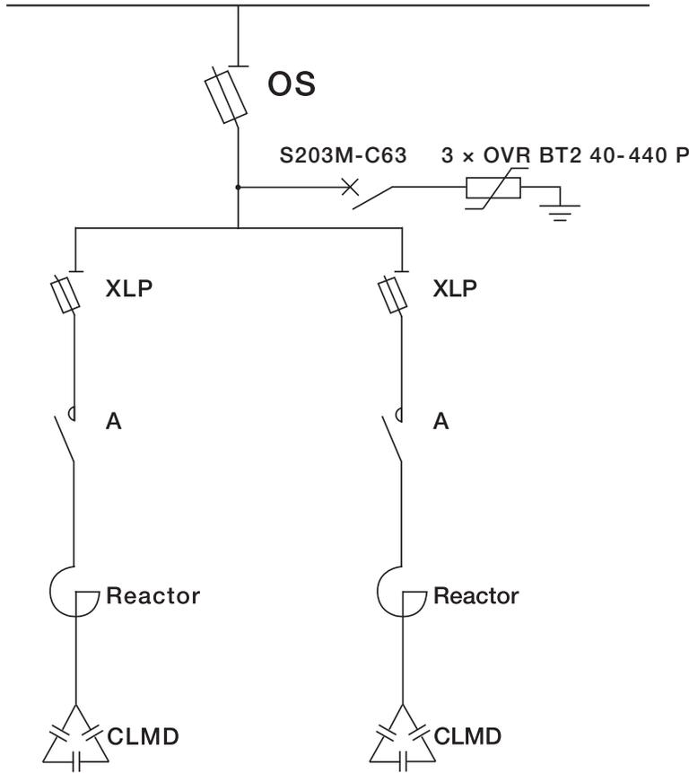
外界引入的电力线路，由于雷电、操作和谐振等原因均可能产生过电压，危害低压配电设备，所以在无功补偿柜内加装防雷设备以防止过电压。
