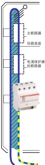
无保护电缆 ←  $D > 30\text{ cm}$  → 带保护电缆
