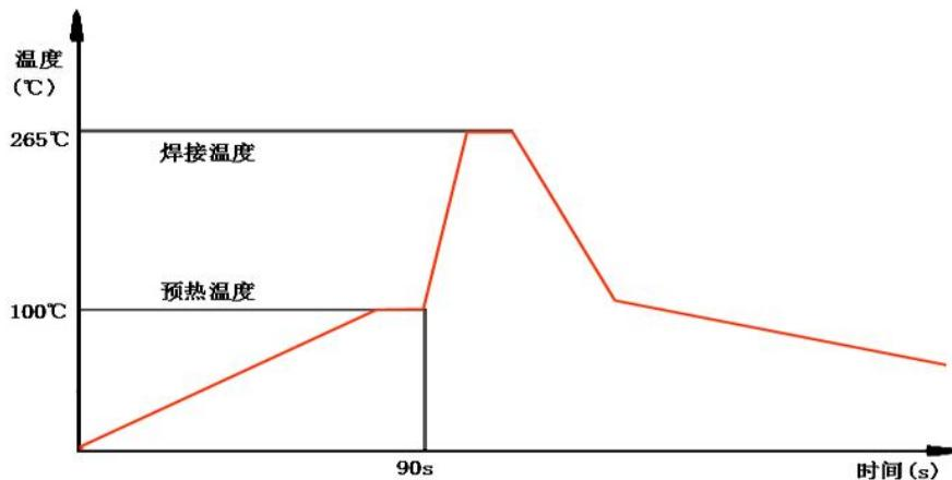
贴片压敏利用瓷片本体的银电极做焊接电极之一，请注意焊接温度和时间（推荐260℃ 3-8秒）
