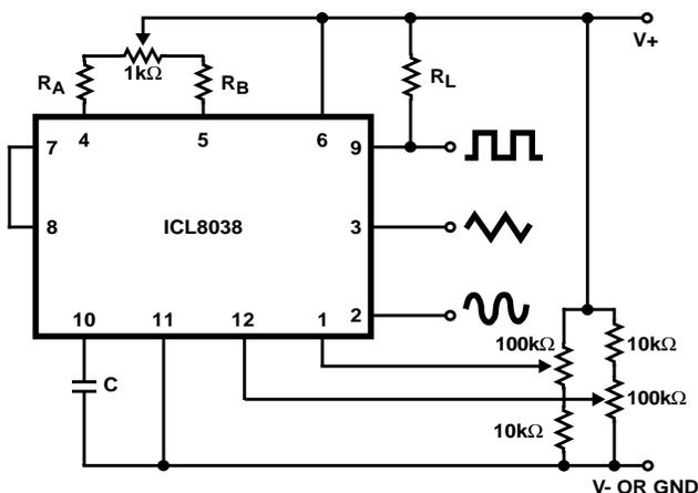
**FIGURE 4. CONNECTION TO ACHIEVE MINIMUM SINE WAVE DISTORTION**
