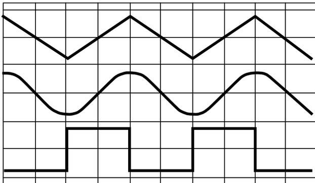
FIGURE 2A. SQUARE WAVE DUTY CYCLE - 50%
