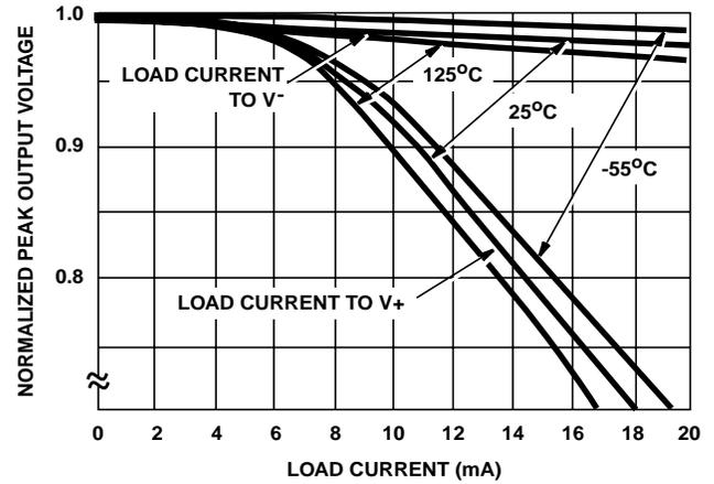
**FIGURE 16. TRIANGLE WAVE OUTPUT VOLTAGE vs LOAD CURRENT**
