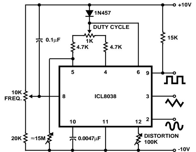
FIGURE 8. VARIABLE AUDIO OSCILLATOR, 20Hz TO 20kHz
